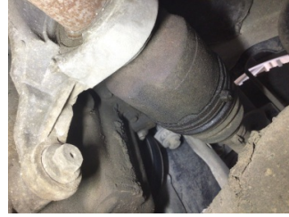
Ön aks, Aks mili, sol > Yağ Kaçağı
