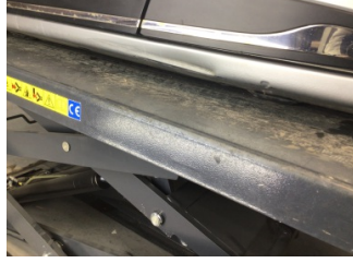
Marşbiyel, sol, Marşbiyel, sol > Hasarlı
