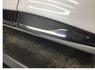
Kapı, sol arka, Kapı bandı > Deforme Olmuş
