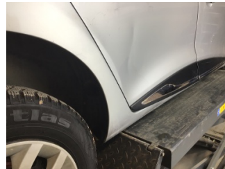
Kapı, sağ arka, Kapı, sağ arka > Hasarlı
