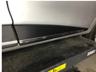
Kapı, sağ ön, Kapı bandı > Deforme Olmuş
