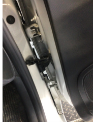
Kapı, sağ ön, Kapı gergisi > Ses Yapıyor
