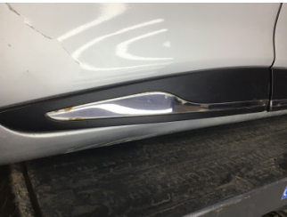
Kapı, sağ arka, Kapı bandı > Deforme Olmuş
