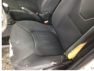
Koltuklar, ön, Koltuk döşemesi, sol ön > Hasarlı
