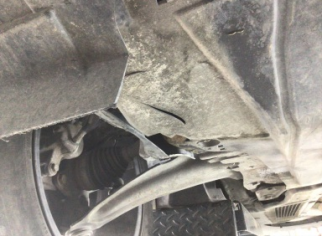
Motor, Alt muhafaza > Hasarlı
