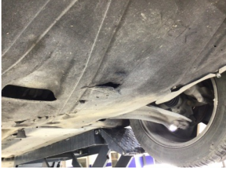
Motor, Alt muhafaza > Hasarlı
