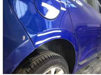
Çamurluk, sağ arka, Çamurluk ağı > Çizik
