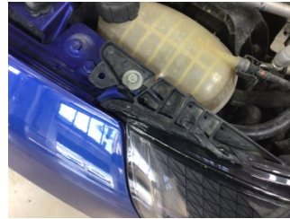
Farlar, Far bağlantı ayağı, sağ > Hasarlı
