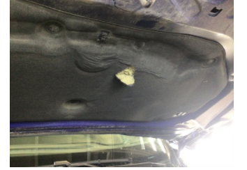
Motor kaputu, izolasyon döşemesi > Hasarlı
