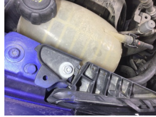
Farlar, Far bağlantı ayağı, sağ > Hasarlı
