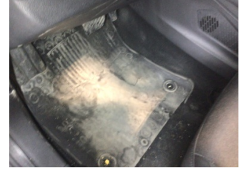
Taban, Paspaslar > Deforme Olmuş
