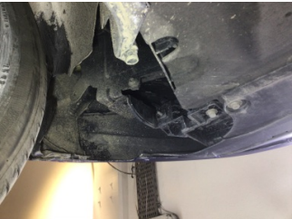
Motor, Alt muhafaza > Hasarlı
