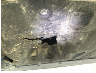
Motor, Alt muhafaza > Hasarlı
