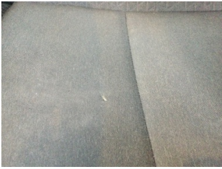
Döşemeler/Kapaklar, Döşemeler/Kapaklar > Yakıcı Madde ile Zarar Görmüş
