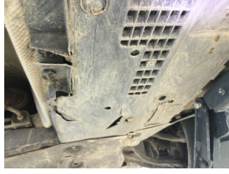
Kaporta, Muhafaza, orta > Hasarlı
