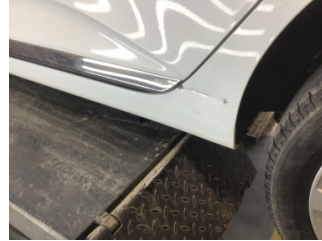
Kapı, sol arka, Kapı bandı > Çizik
