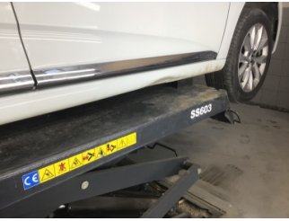
Marşbiyel, sağ, Marşbiyel, sağ > Hasarlı
