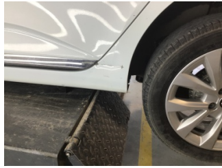
Marşbiyel, sol, Marşbiyel, sol > Hasarlı
