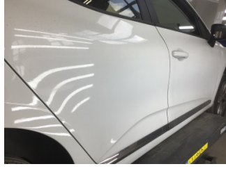
Kapı, sağ arka, Kapı, sağ arka > Ezik
