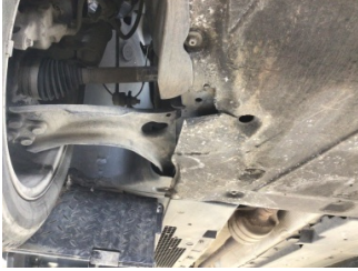
Motor, Alt muhafaza > Hasarlı
