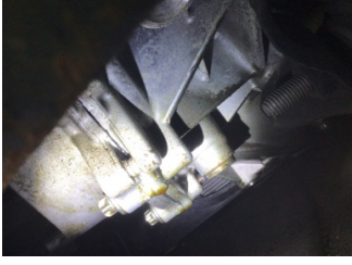
Şanzıman, Şanzıman > Yağ Kaçağı
