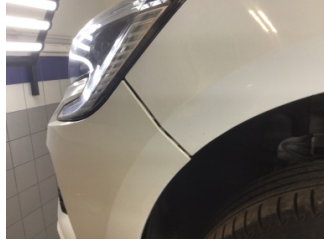
Tampon, ön, Ön tampon > Sabitlemesi Hatalı
