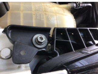
Farlar, Far bağlantı ayağı, sağ > Hasarlı
