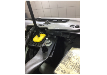
Farlar, Far bağlantı ayağı, sağ > Standart Dışı Onarım
