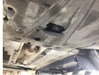
Motor, Alt muhafaza > Hasarlı
