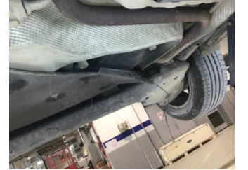
Motor, Alt muhafaza > Hasarlı
