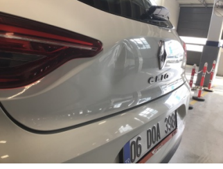
Bagaj kapağı/kapısı, Bagaj kapısı > Ezik
