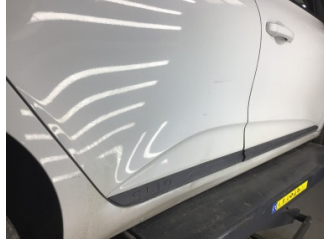
Kapı, sağ arka, Kapı, sağ arka > Ezik
