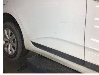
Kapı, sağ arka, Kapı, sağ arka > Ezik
