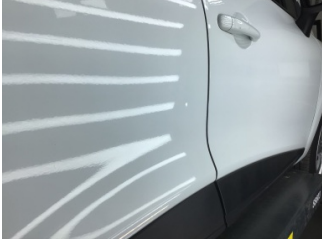
Kapı, sağ arka, Kapı, sağ arka > Ezik
