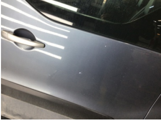
Kapı, sol arka, Kapı, sol arka > Çizik
