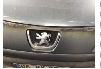
Tampon, ön, Ön tampon > Deforme Olmuş
