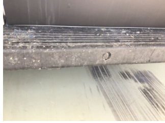
Tampon, arka, Park sensörü, sağ > Hasarlı
