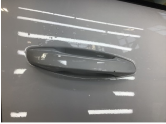
Kapı, sağ ön, Kapı kolu, dış > Çizik
