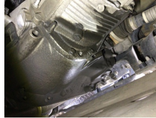
Şanzıman, Şanzıman > Yağ Kaçağı
