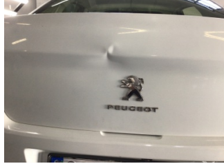
Bagaj kapağı/kapısı, Bagaj kapısı > Ezik
