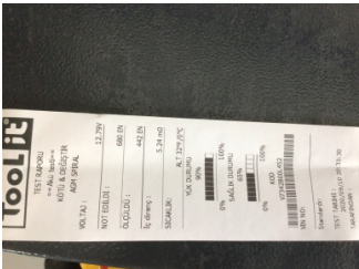
Elektrik donanımı/Pano, Akü > Test Sonucu
