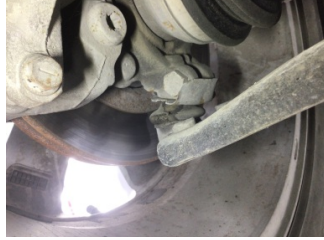
Ön aks, Salıncak, ön sağ alt > Deforme Olmuş
