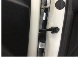
Kapı, sol ön, Kapı gergisi > Ses Yapıyor
