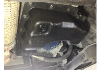
Motor, Yağ karteri > Yağ Kaçığı
