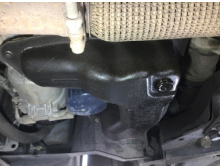
Motor, Yağ karteri > Yağ Kaçığı
