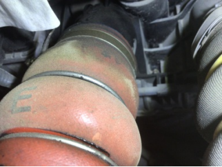
Motor, Turbo hortumları > Yağ Kaçığı
