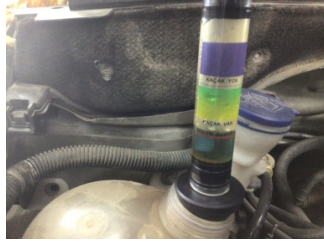
Motor, Silindir kapağı contası > Test Sonucu
