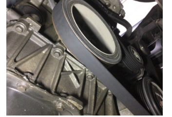
Motor, Triger zinciri kapağı > Yağ Kaçağı
