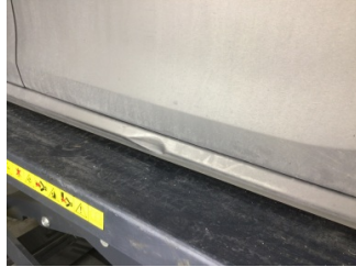
Marşbiyel, sağ, Marşbiyel, sağ > Hasarlı
