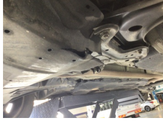
Motor, Alt muhafaza > Hasarlı
