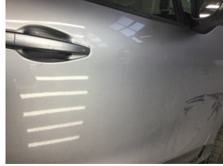
Kapı, sağ ön, Kapı, sağ ön > Çizik
