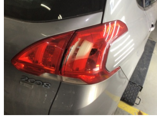
Arka lambalar, Arka lambalar, sağ > Hasarlı
