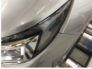
Çamurluk, sol, Çamurluk, sol > Sabitlemesi Hatalı
