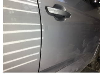
Kapı, sağ ön, Kapı, sağ ön > Noktasal Ezik
