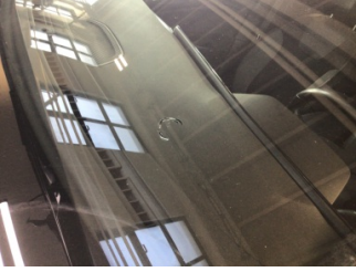
Camlar, Ön cam > Hasarlı
