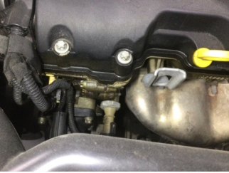
Motor, Motor üst kapağı, plastik > Yağ Kaçağı
