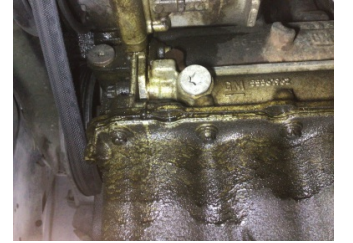
Motor, Triger zinciri kapağı > Yağ Kaçağı
