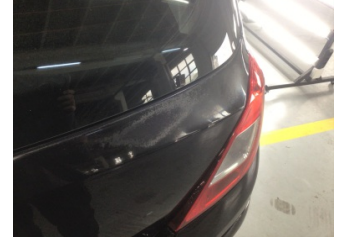
Bagaj kapağı/kapısı, Bagaj kapısı > Solmuş
