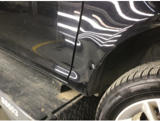
Çamurluk, sağ, Çamurluk, sağ > Hasarlı
