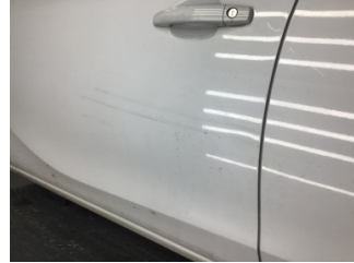
Kapı, sol ön, Kapı, sol ön > Çizik
