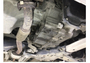
Şanzıman, Şanzıman > Yağ Kaçağı
