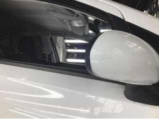
Dikiz aynası, sağ, Dış dikiz aynası > Çizik
