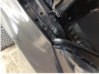
Farlar, Far, sağ > Hasarlı
