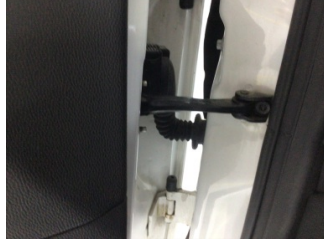
Kapı, sol ön, Kapı gergisi > Ses Yapıyor
