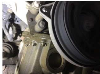
Motor, Yağ karteri contası > Yağ Kaçağı
