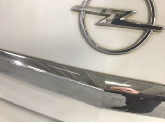
Bagaj kapağı/kapısı, Bagaj kapısı > Noktasal Ezik
