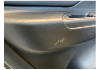
Döşemeler/Kapaklar, Döşemeler/Kapaklar > Deforme Olmuş
