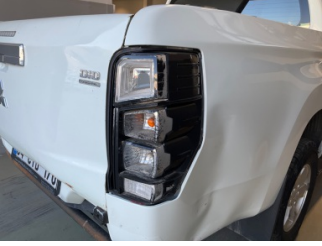
Arka lambalar, Arka lambalar, sağ > Hasarlı
