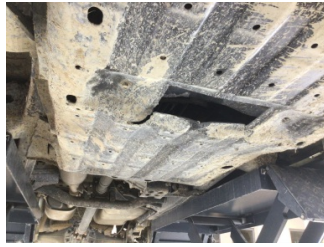
Motor, Alt muhafaza > Hasarlı
