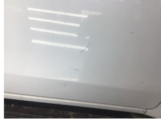
Kapı, sağ ön, Kapı, sağ ön > Çizik
