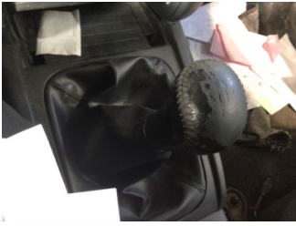
Şanzıman, Vites topuzu > Deforme Olmuş
