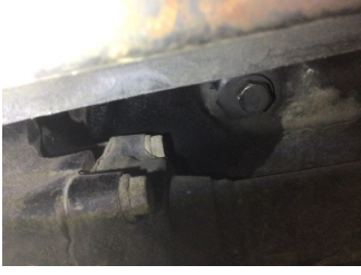
Motor, Yağ karteri > Yağ Kaçağı
