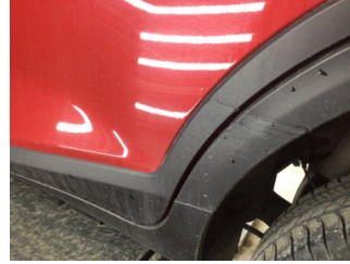
Kapı, sol arka, Kapı, sol arka > Çizik
