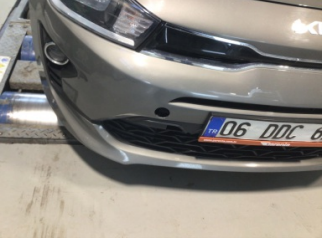
Tampon, ön, Çeki demir kapağı > Sökülmüş-Yok
