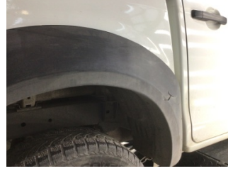
Çamurluk, sağ arka, Çamurluk ağız > Hasarlı
