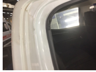
Kapı, sağ arka, Kapı fitili > Hasarlı
