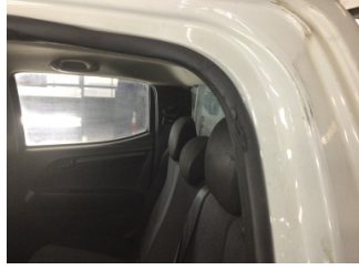
Kapı, sol arka, Kapı fitili > Hasarlı
