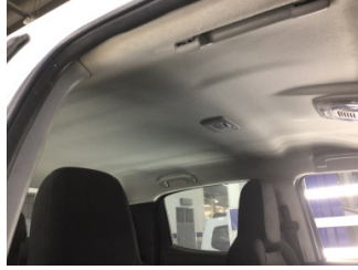
Döşemeler/Kapaklar, Tavan döşemesi > Kirlenmiş
