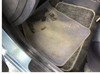
Taban, Paspaslar > Deforme Olmuş
