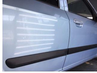
Kapı, sağ arka, Kapı, sağ arka > Ezik
