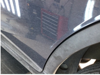
Kapı, sol arka, Kapı, sol arka > Çizik
