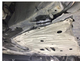
Motor, Alt muhafaza > Hasarlı
