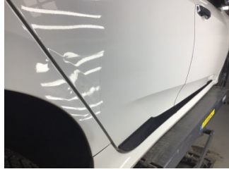
Kapı, sağ arka, Kapı, sağ arka > Ezik
