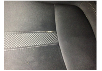
Koltuklar, ön, Koltuk, sol ön > Deforme Olmuş
