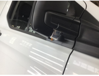
Dikiz aynası, sağ, Sinyal lambası > Hasarlı
