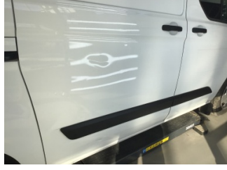
Kapı, sağ arka, Kapı, sağ arka > Ezik
