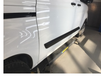
Kapı, sağ arka, Kapı, sağ arka > Ezik
