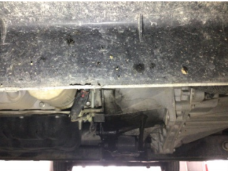
Motor, Yağ karteri contası > Yağ Kaçağı
