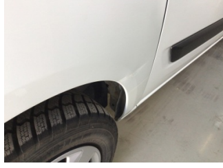
Çamurluk, sağ arka, Çamurluk, sağ arka > Ezik
