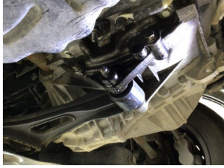
Şanzıman, Şanzıman > Yağ Kaçağı
