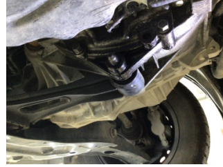
Şanzıman, Şanzıman > Yağ Kaçağı
