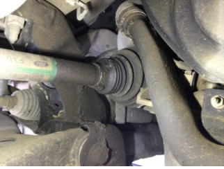
Ön aks, Aks mili, sağ > Yağ Kaçağı
