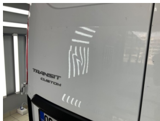
Bagaj kapağı/kapısı, Bagaj kapısı > Ezik
