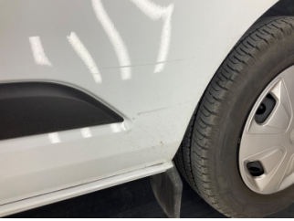
Kapı, sağ ön, Kapı, sağ ön > Çizik
