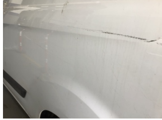
Çamurluk, sol arka, Çamurluk, sol arka > Çizik
